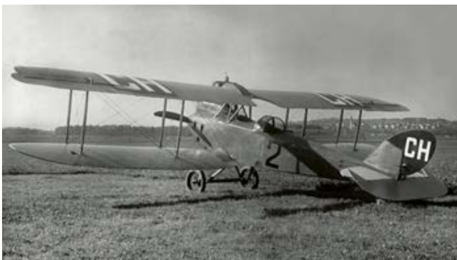
Der von den Kondor-Flugzeugwerken, Gelsenkirchen, in Lizenz gebaute LVG C.V bot neben dem Piloten in einem offenen, mit Plexiglashaube halbwegs geschützten Sitz zwei Passagieren Platz – hier die Nr. 2 mit CH-Kennzeichen.
